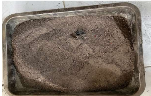
Gambar 3 Abu Incinerator setelah di pisahkan dengan limbah yang susah terbakar
