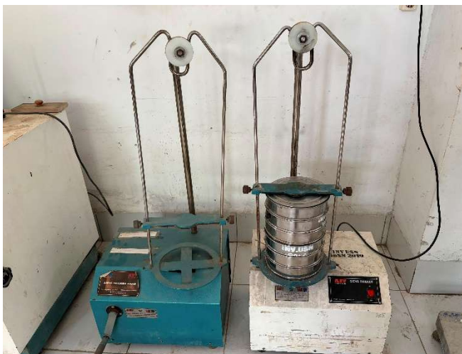
Gambar 4 Pengujian Analisa Saringan Abu Incinerator
