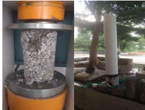
Gambar 3. Pengujian Kuat Tekan dan Permeabilitas
