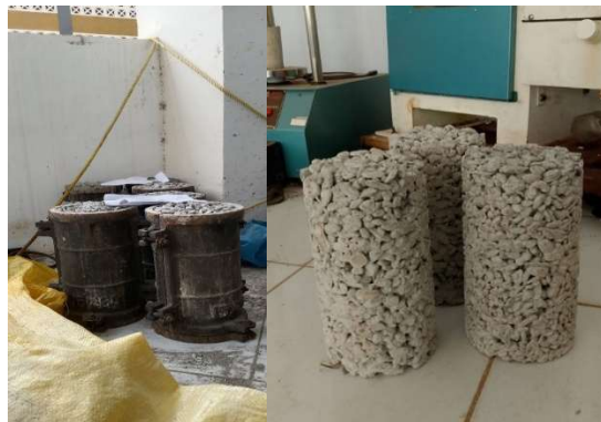
Gambar 2. Cetakan Silinder dan Sampel yang telah dikeluarkan dari cetakan
