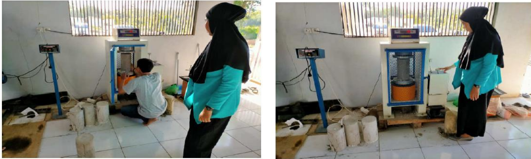
Gambar 9. Proses pengujian kuat tekan sampel beton
