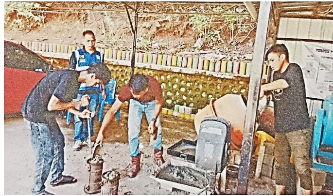
Gambar 2. Proses Pembuatan Benda Uji Sillinder
